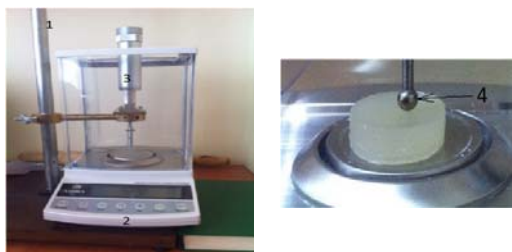
Рис. 2. Схема экспериментальной установки: 1) штатив, 2) весы, 3) микрометр со специальной насадкой для шариков, 4) фантом с шарообразным индентором
