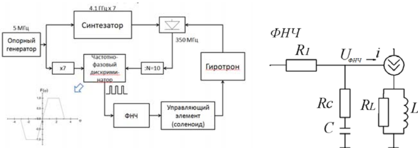
Рис. Схема системы ФАПЧ (слева) и схема фильтра нижних частот с управляющим элементом (справа).
