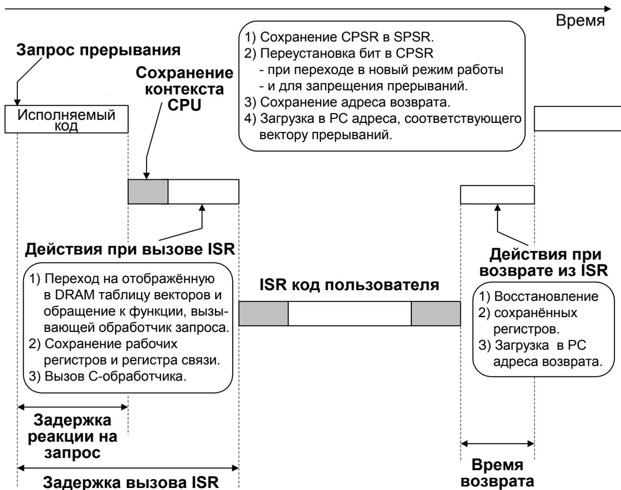
Рис. 4.25. Временная диаграмма последовательности обработки запроса прерывания
