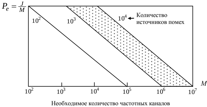
Рис. 3.45. Зависимость необходимого количества частотных каналов от количества «пораженных» помехой каналов и количества источников помех
