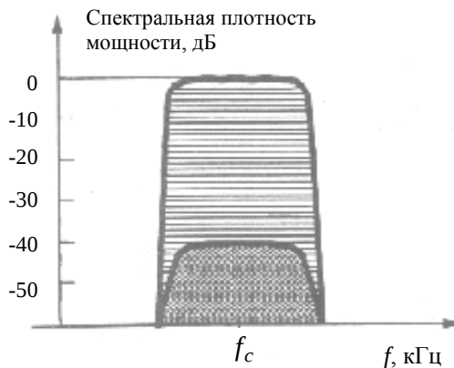
Рис. 1.8. Помеха по основному каналу приема в системе с семиэлементной структурой групп и повторным использованием частот ( k=7 ). Показана только одна помеха по основному каналу приема (закрашено темным). Спектральная плотность мощности отображена в децибелах относительно спектральной плотности полезного сигнала
