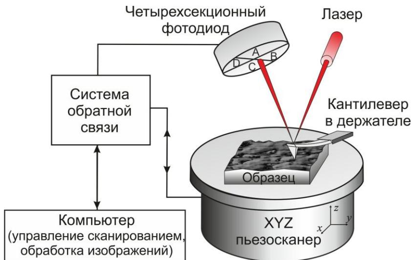
Рисунок 7. Схематическое изображение АСМ
