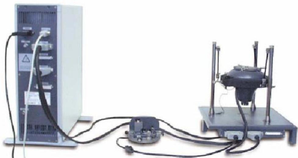
Рис. 13. Основные блоки атомно-силового микроскопа
